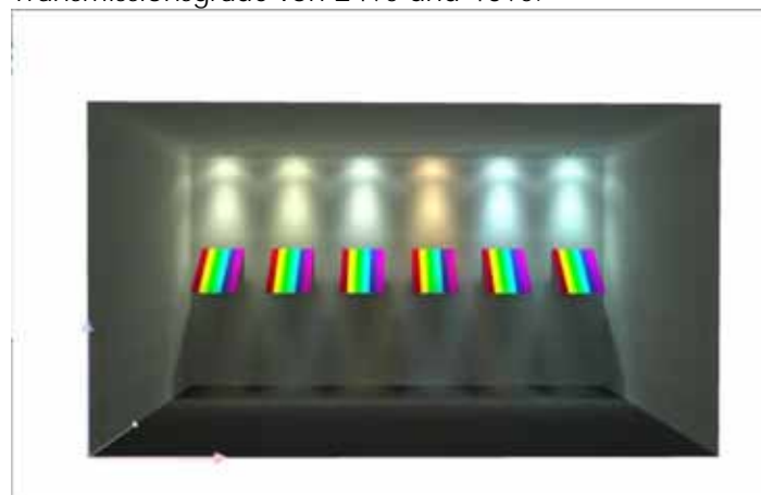
Abbildung 203 Verschiedene Lampenspektren, gleicher Farbfilter. Von links: Glühlampe, Leuchtstoff 830, D65, HST, HCI, HIT
